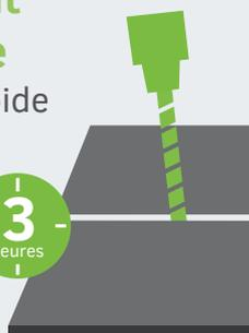
**1** Percez plusieurs trous espacés d'environ 5 cm dans le joint où le carrelage sonne creux ou est détaché. Utilisez pour cela la petite mèche livrée. Forez progressivement afin d'éviter que la mèche ne se casse ou s'émousse.
